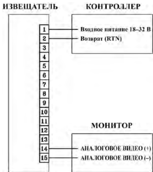
Рис. 14. Аналоговый видеовыход в вариантах электрической схемы 1 и 2
